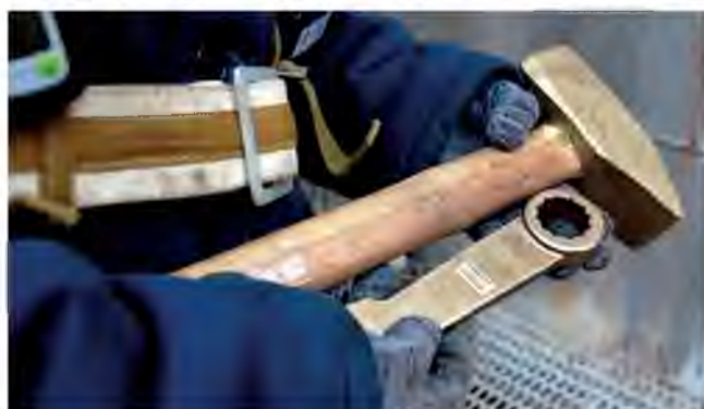
Шаг шестой. Применяйте переносные лестницы и инструменты из неискрящих материалов. Допустимо пользоваться взрывозащищёнными переносными светильниками с напряжением не более 12 вольт
