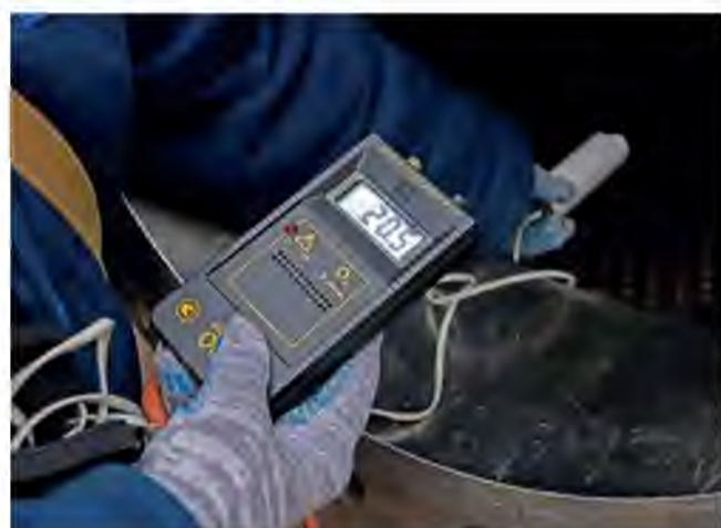
Шаг второй. Сотрудники лаборатории должны провести анализ воздушной среды на содержание кислорода и опасных веществ
