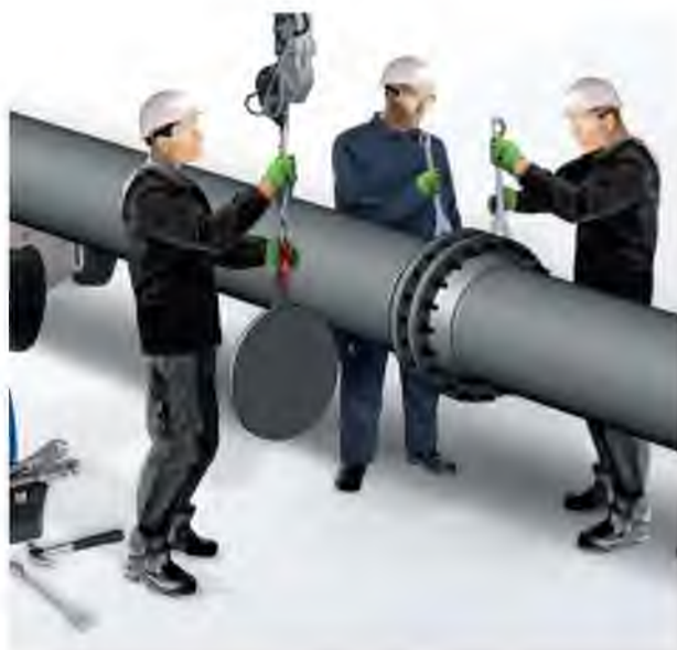
Слева направо – было-стало: быстроразъемные заглушки для технологических трубопроводов можно установить и снять как минимум в десять раз быстрее, чем традиционные
